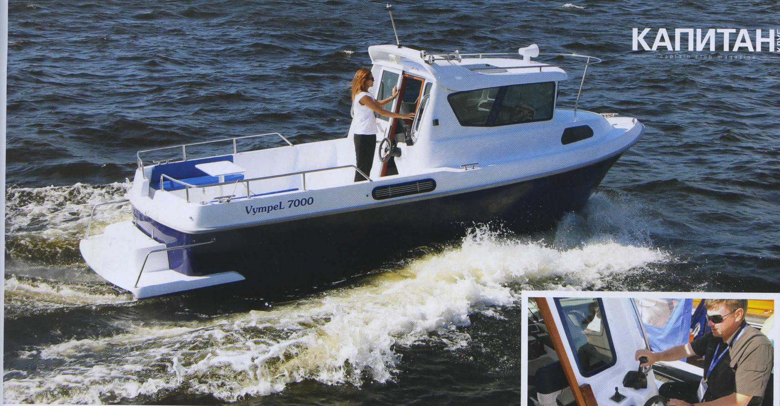
тичен, к тому же снабжен характерным для финских лодок «висячим» релингом, переходящим с крыши рубки на стойку над капом носовой каюты. Бывалый матрос при швартовке или отдаче якоря легко справится со своей задачей. Удобна и средняя швартовная утка у переборки рубки — с ней можно сладить и в одиночку.
